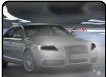
Com a funcionalidade HLC, você pode identificar áreas que normalmente ficam ofuscadas com um excesso de incidência de luz. Por exemplo: uma placa de carro.
